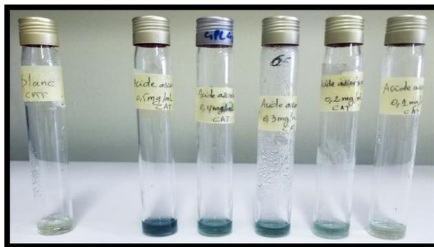
**Figure 27** Gamme d'étalonnage de l'acide ascorbique.
